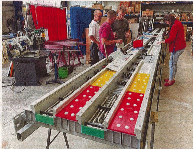
In der Halle der Firma Riedel in Raschau wurden die Segmente der 2007 erstmals installierten Schanzen-Anlaufspur generalüberholt. FOTO: PETER RIEDEL
